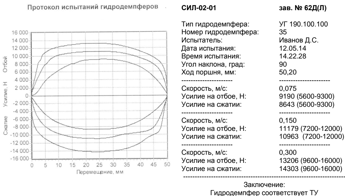
Рисунок 6.2 – Пример протокола испытаний гидрогасителя на стенде “ЭНГА”
